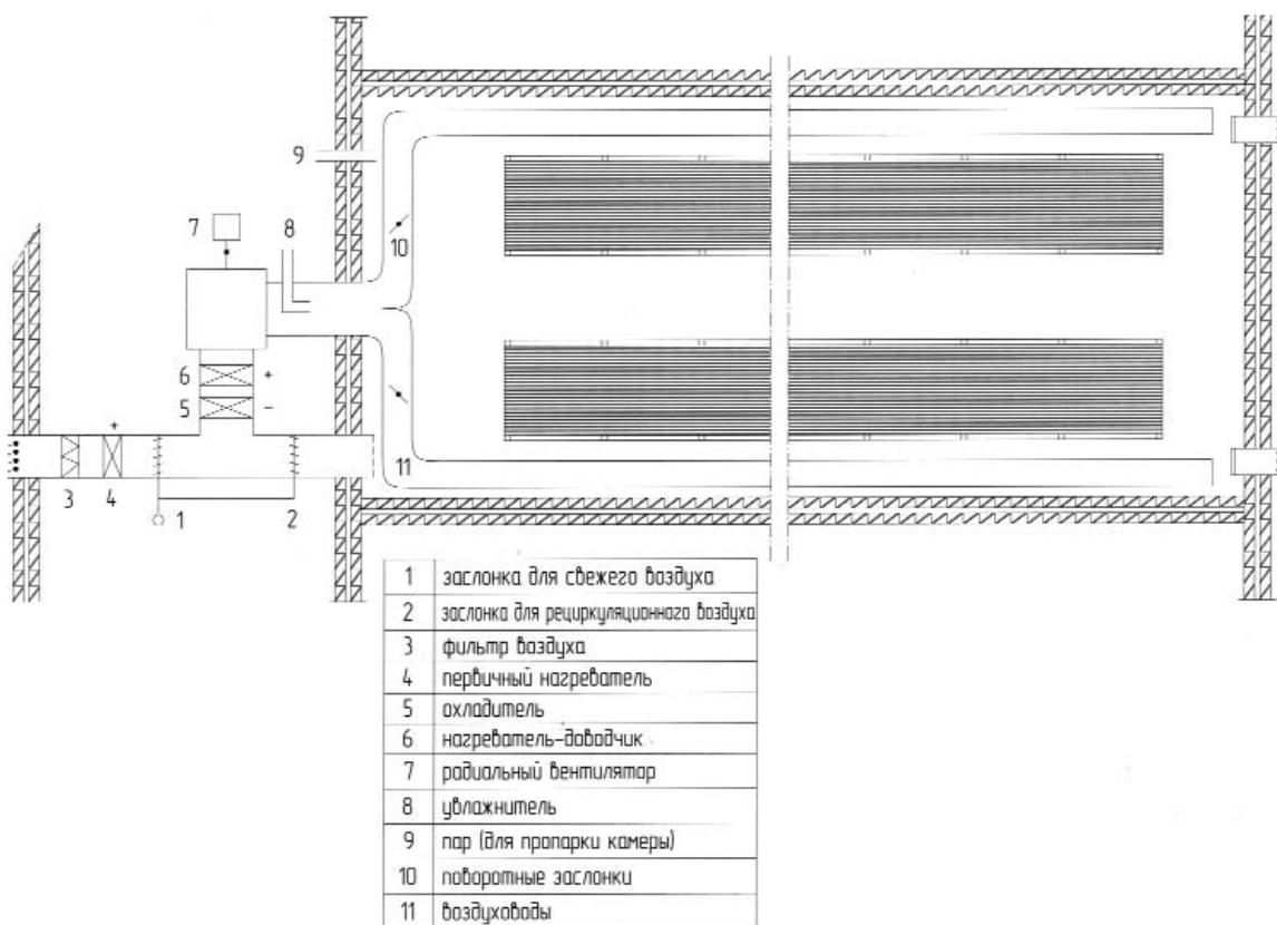
рашивании вешенки у нас, в основном в длинных и узких камерах. Форсунки делают из больших стаканчиков для пива. В общем, скорость истечения воздуха из форсунок должна быть не менее длины струи до стены в метрах, например 8-10 м/сек. Стеллажи располагают по-перек камеры. В камерах вытяжные окна могут быть в потолке, в торце или боковых стенах.
